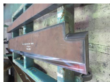
耐摩耗鋼HARDOX600 アンビル(開先加工)
