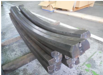
耐摩耗鋼HARDOX400 レール曲げ
