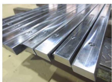
耐摩耗鋼HARDOX450 レール機械加工
