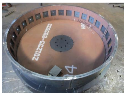
耐摩耗鋼HARDOX500 摩耗試験装置
