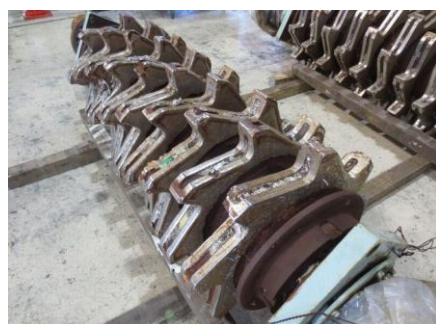
耐摩耗鋼HARDOX550 スプロケット(溶断加工)
