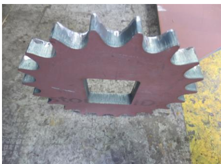
耐摩耗鋼HARDOX550 スプロケット(レーザー加工)
