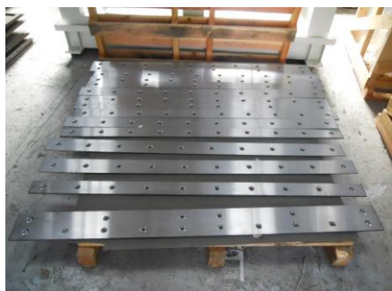
耐摩耗鋼HARDOX500 ライナー研磨と穴加工
