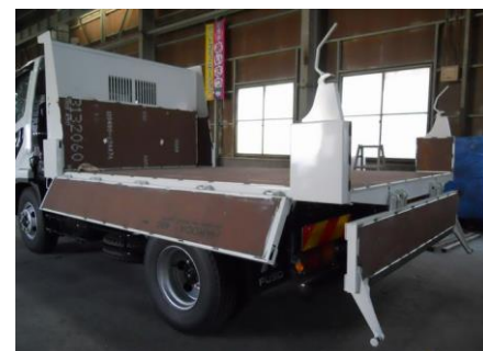
耐摩耗鋼HARDOX450 トラック床板補強
