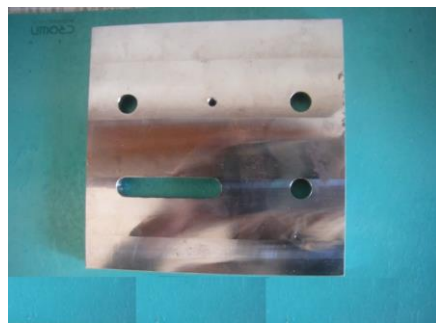
耐摩耗鋼HARDOX500 プレート(研磨加工)
