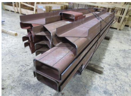
耐摩耗鋼板HARDOX500TUF チャンネル曲げ
