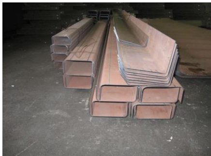
耐摩耗鋼HARDOX450 チャンネル・アングル曲げ
