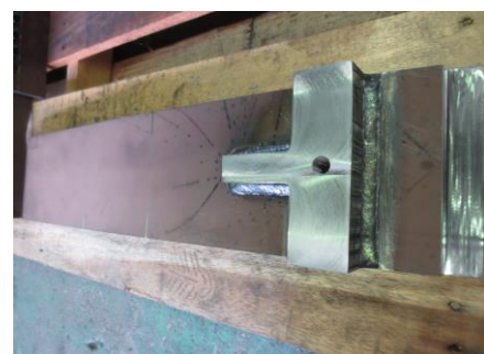
耐摩耗鋼HARDOX500 プレート(ネジ加工)
