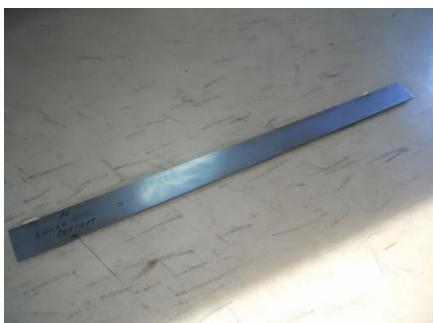
耐摩耗鋼HARDOX400 プレート(圧延加工)
