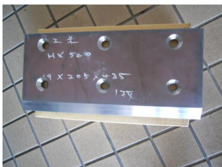
耐摩耗鋼HARDOX500 ライナー(開先と皿穴加工)
