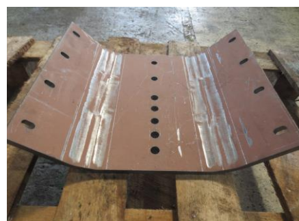
耐摩耗鋼HARDOX500 ライナー(曲げ加工)
