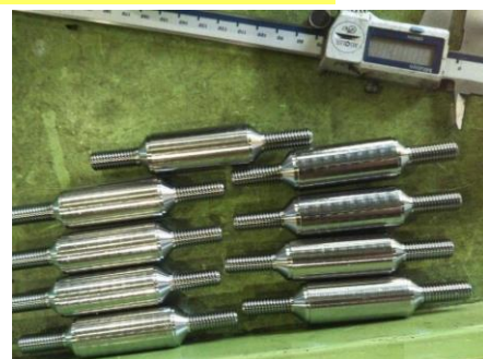
耐摩耗鋼HARDOX500 ネジ加工
