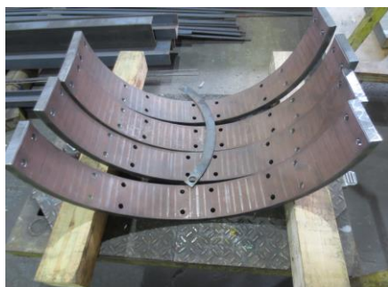
耐摩耗鋼HARDOX450 ライナー(曲げ加工)
