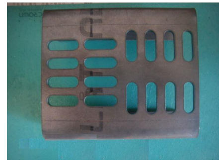
STRENX700 曲げとレーザ加工
