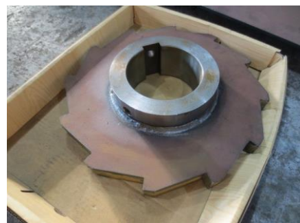
耐摩耗鋼HARDOX500 スプロケット(レーザー加工)
