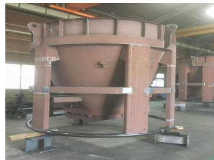
耐摩耗鋼HARDOX450 コンクリートバケット
