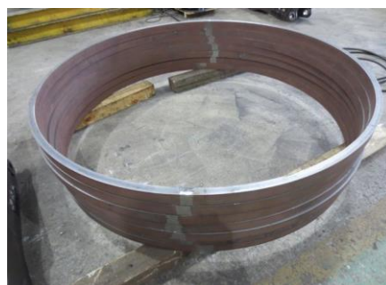
耐摩耗鋼HARDOX500 レール曲げ
