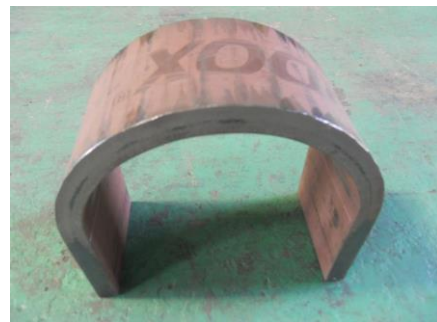
耐摩耗鋼板HARDOX500 t19-R100曲げ部品
