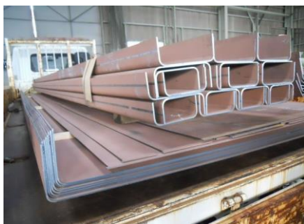
耐摩耗鋼HARDOX450 チャンネル(L=6000)
