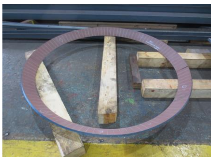
耐摩耗鋼HARDOX500 ライナー(曲げ加工)
