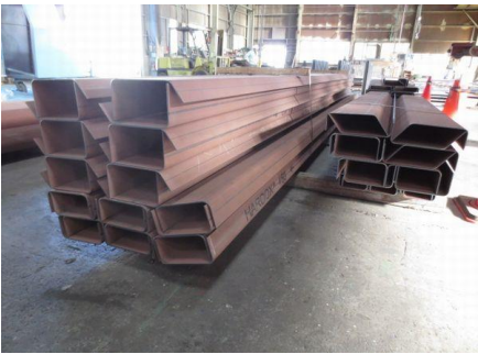
耐摩耗鋼HARDOX450 チャンネル(L=6000)
