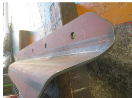
耐摩耗鋼HARDOX450 ライナー(曲げ加工)
