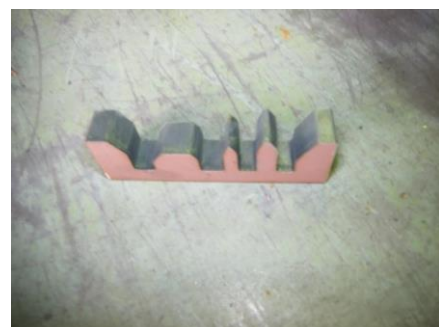
耐摩耗鋼HARDOX550 歯状部品(レーザー加工)
