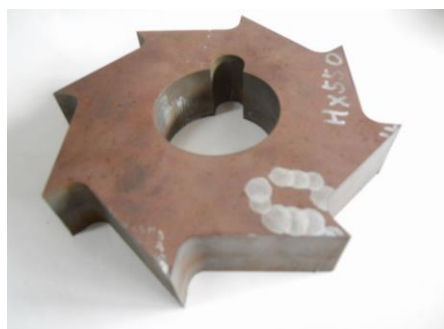
耐摩耗鋼HARDOX550 回転刃(ウォータージェット加工)
