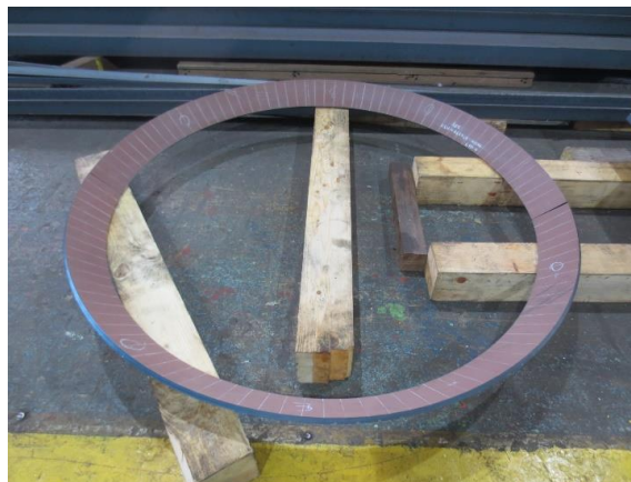
耐摩耗鋼HARDOX500 ライナー(曲げ加工)
