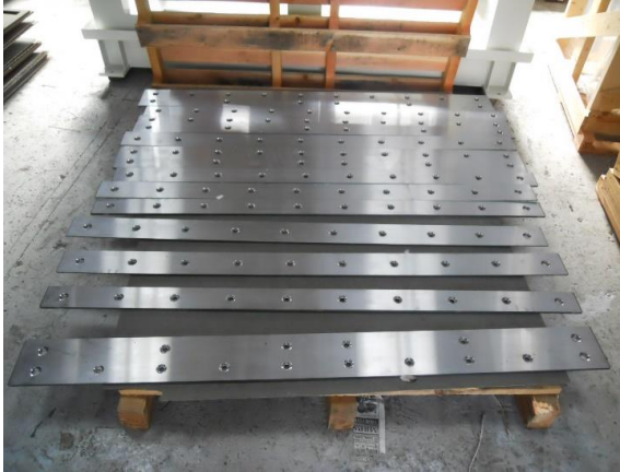
耐摩耗鋼HARDOX500 ライナー研磨と穴加工
