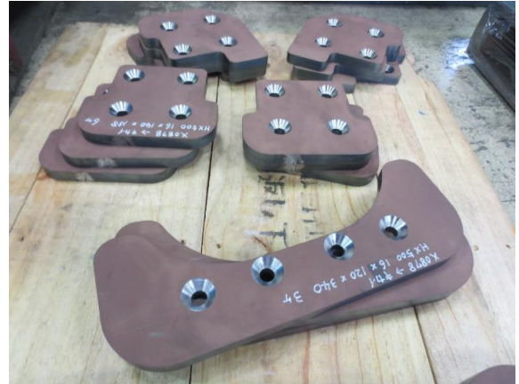
耐摩耗鋼HARDOX500 ライナー(機械加工)
