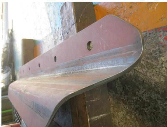
耐摩耗鋼HARDOX450 ライナー(曲げ加工)
