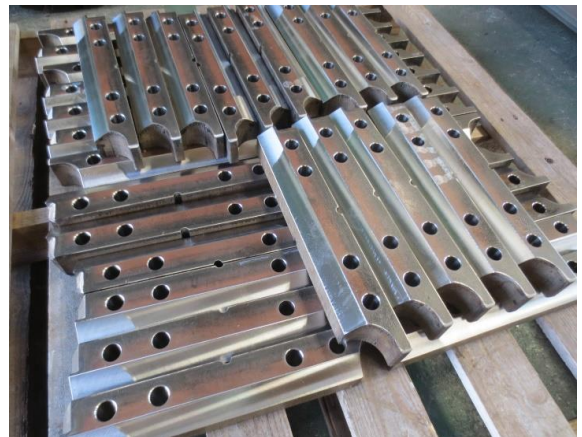
耐摩耗鋼HARDOX500 ライナー(機械加工)
