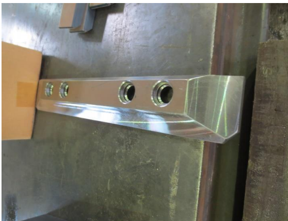
耐摩耗鋼HARDOX500 ライナー(機械加工)
