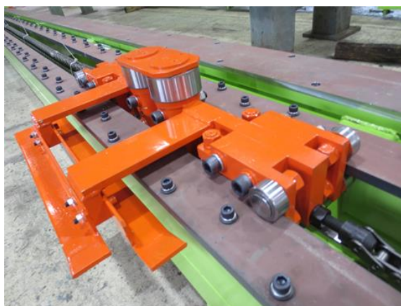
HARDOX500 大型塗装搬送設備レール
