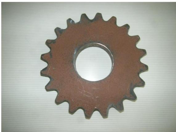
HARDOX550 スプロケット溶断加工
