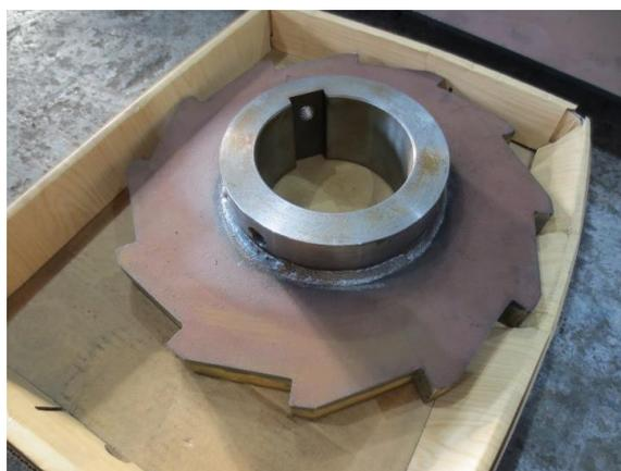
HARDOX550 スプロケットレーザー加工
