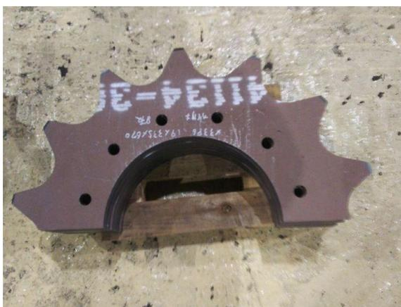
HARDOX500 セクターギアレーザー加工
