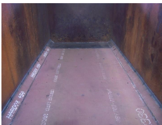
HARDOX450 コンテナ床張り
