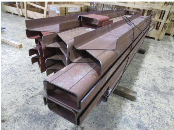
HARDOX500TUF チャンネル曲げ
