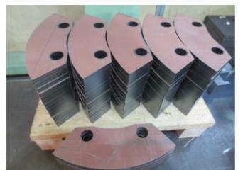
耐熱・耐摩耗鋼板Hardox
