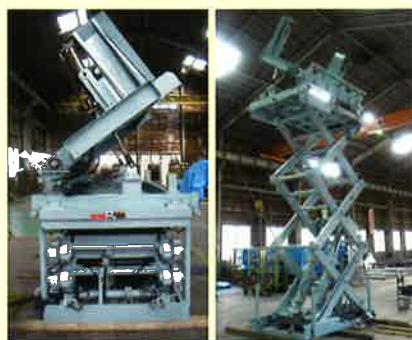
昇降設備 紙の原料である パルパーを熔解 槽へ投入するリ フター
