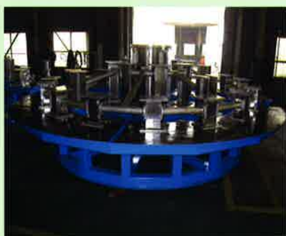
組立治具 燃料タンクの 製作設備
