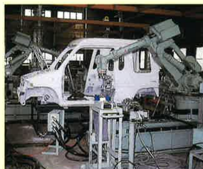
組立設備 自動車ガラスを ボディに貼り付 ける設備 (ガラ スプライマー塗 布装置)
