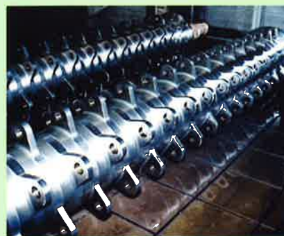
精密加工部品 ハンマー機構を 利用した粉碎機 械のシャフト
