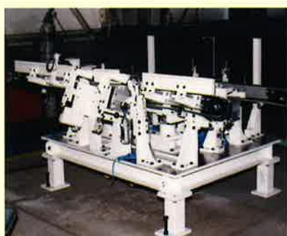
溶接治具 自動車の フロントドアを 溶接する設備
