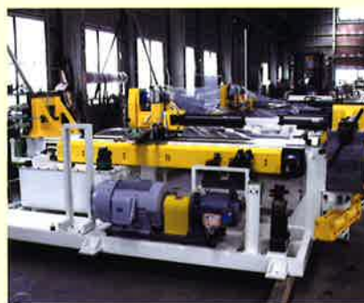
専用機 パイプを曲げる 設備 (NCパイプ ベンダー)
