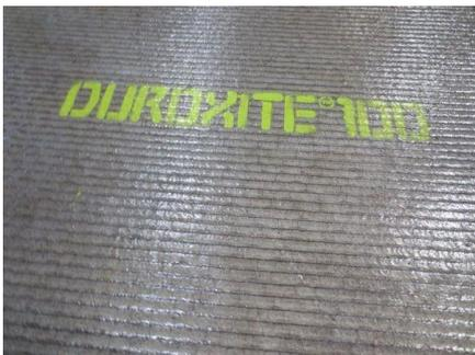
硬化肉盛耐摩耗鋼板DUROXITE100鋼板
