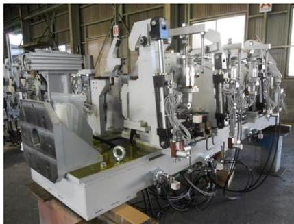
建機フレーム溶接治具
