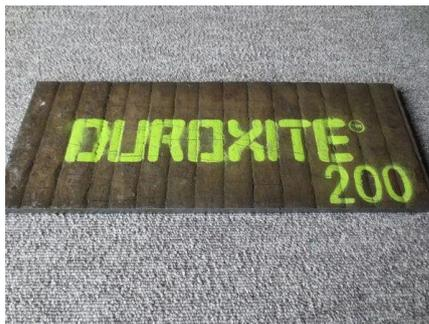
硬化肉盛耐摩耗鋼板DUROXITE200鋼板
