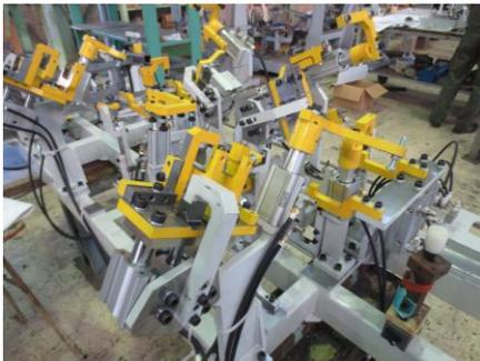
建機フレームSUB溶接治具
