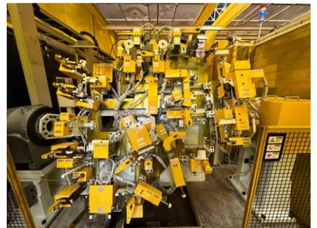
フレーム溶接治具製
