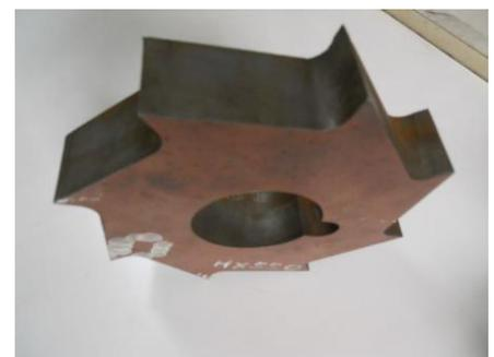
高強度・高硬度耐摩耗鋼HARDOX550
