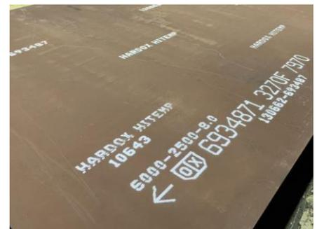
耐熱・耐摩耗鋼板HARDOX HITEMP
