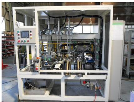
クラッチギヤ自動検査装置
