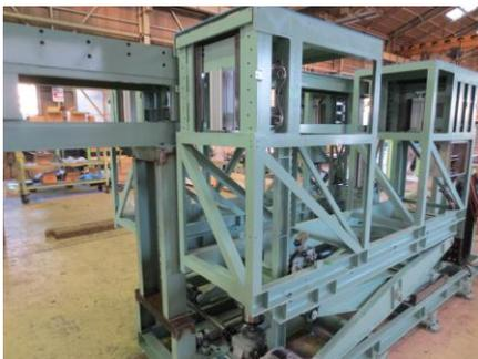
油漏自動検査装置
