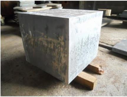
極厚溶断加工 t310 (GFS45C)
