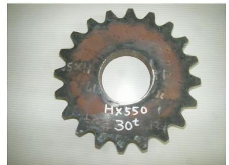
溶断加工 t30 (HARDOX550)
