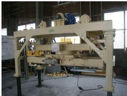
旋回、昇降、スライド移載装置
