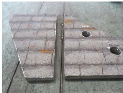
レーザー切断加工 (肉盛鋼板DUROXITE)
