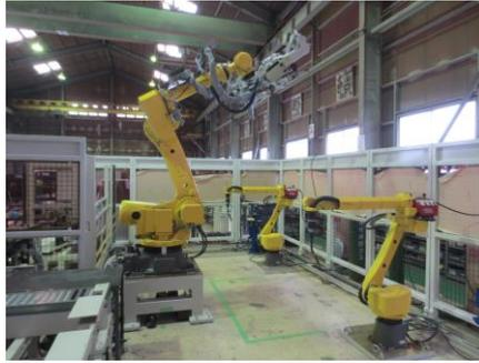
斜材自動溶接装置
