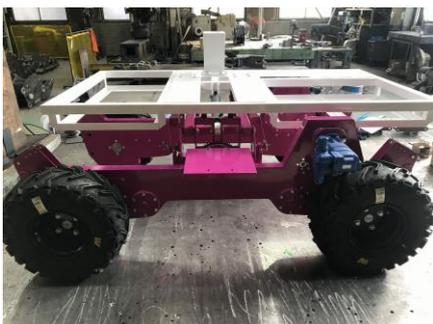
ラジコン式階段造林作業機
