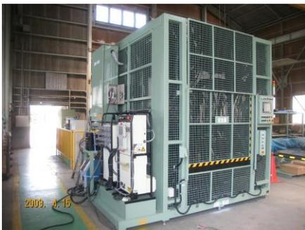
フレーム自動溶接装置
