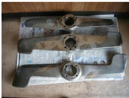
ターボミキサー羽根 機械加工
