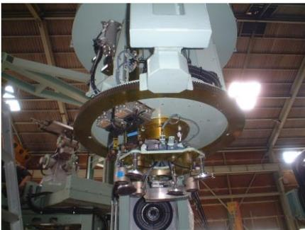
**固化容器蓋取り外し・反転装置**
