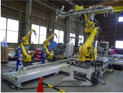
建材組立自動溶接装置
