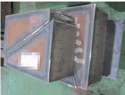
極厚溶断加工 t100 (HARDOX500)
