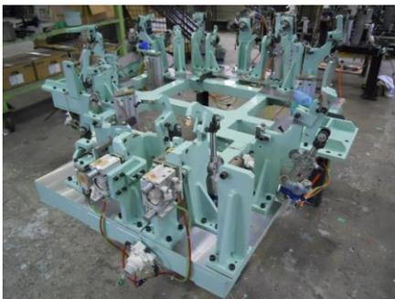
建機ドアフレーム溶接治具
