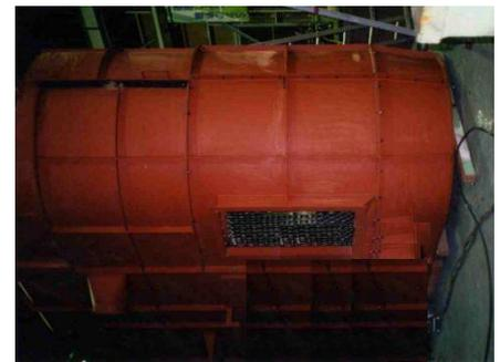
破碎圧縮設備投入タンク
