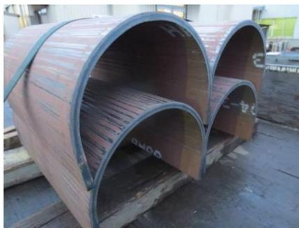
高強度・高硬度耐摩耗鋼HARDOX500
