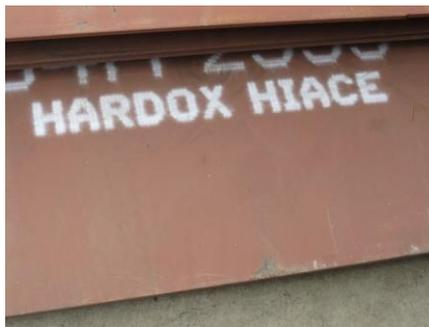
耐腐食・耐摩耗鋼板HARDOX HIACE
