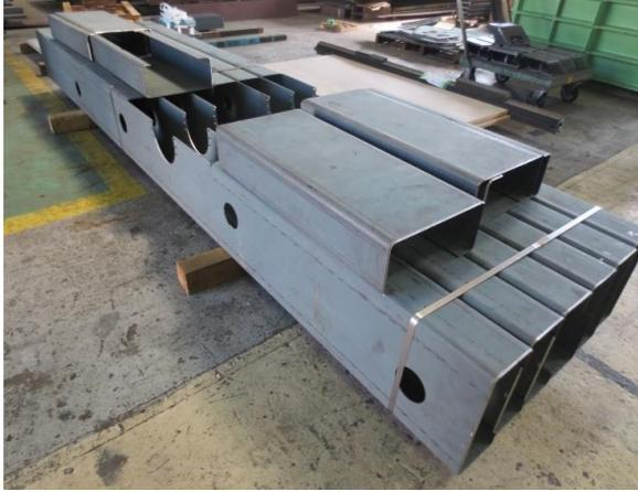
高強度構造用鋼板STERNXは建築・農業機械、特に軽量化が必要な耐荷重構造の用途で使用されています。STERNXは製品の強度、軽量性、安全性を向上させます。
