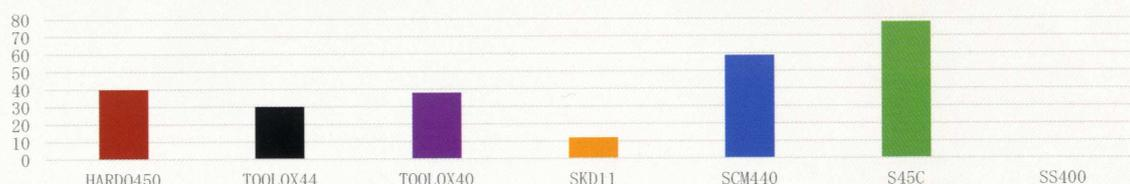
使用温度 (°C) HX450;TX44;TX40 と代表的な工業用鋼材使用温度の比較
