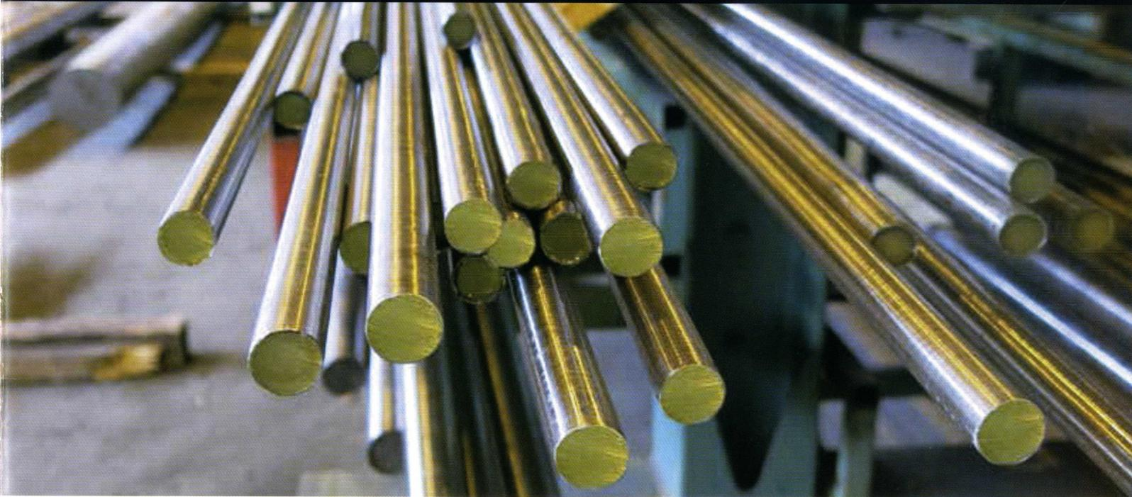
TOOLOX は、残留応力を極限まで減らしたプリハードン鋼です。高強度、高硬度ながら切削性、溶接性が良い鋼材です。また、機械加工後の熱処理が不要な為、時間の節約になります。
