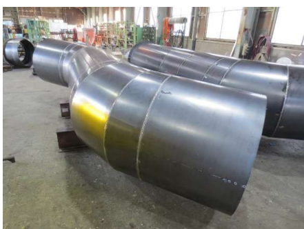
プレス煙道ダクト
