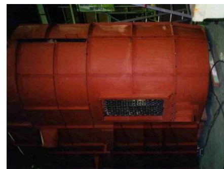
破碎圧縮設備投入タンク
