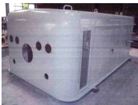
機関室ケーシング
