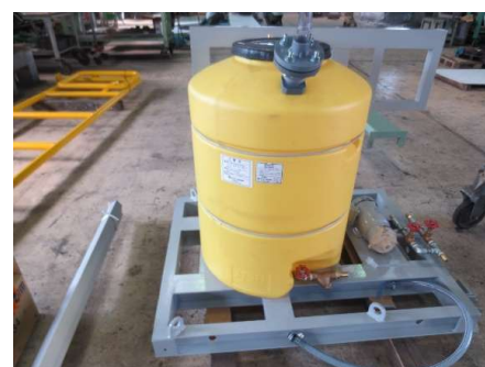
循環水タンク
