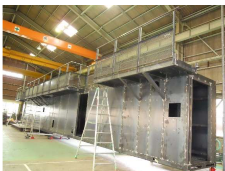
クレーン電気室
