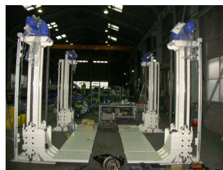
垂直搬送装置 トラクタ検査リフトアップ
