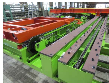
大型塗装ライン搬送設備
