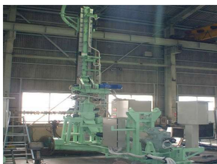
垂直搬送装置 脱珪機
