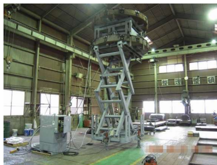
垂直搬送装置 転炉レンガ積装置オーバーホール
