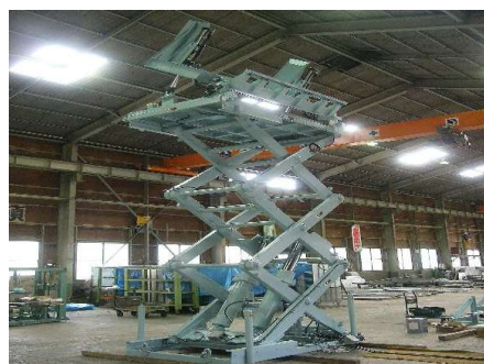
垂直搬送装置 物品投入リフター
