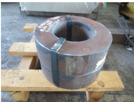
耐摩耗鋼板HARDOX500-t90極厚溶断
