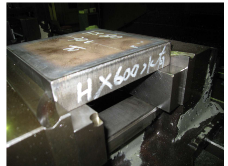
耐摩耗鋼板HARDOX600-t30溶断
