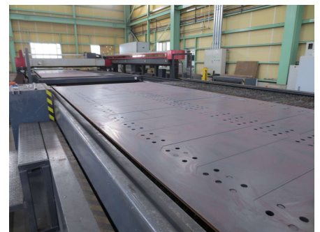
大型レーザー加工機 (MAX t30-6100 × 3050)
