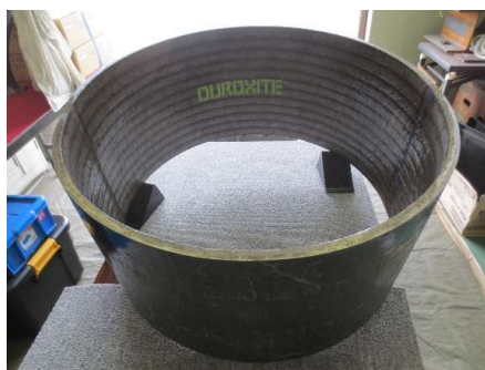
SSAB社耐摩耗肉盛鋼板 DUROXITE100 曲げ加工
