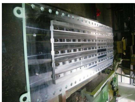
SSAB社高強度・高硬度耐摩耗鋼板 HARDOX500 プレスガイド 機械加工
