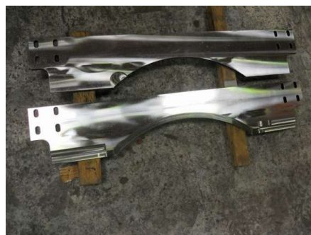
SSAB社高強度・高硬度耐摩耗鋼板 HARDOX600 ベースプレート 機械加工
