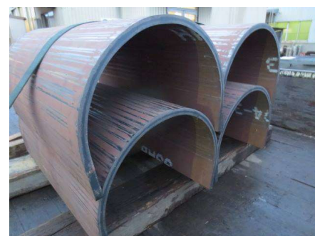
SSAB社高強度・高硬度耐摩耗鋼板 HARDOX500 シュート 曲げ加工
