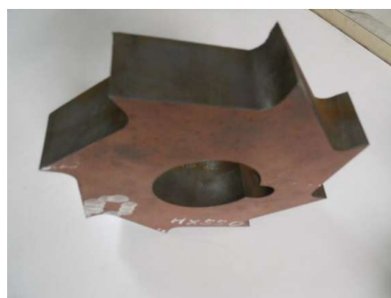
SSAB社高強度・高硬度耐摩耗鋼板 HARDOX550回転刃ウォータージェット
