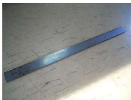
SSAB社高強度・高硬度耐摩耗鋼板 HARDOX400 プレート 圧延加工
