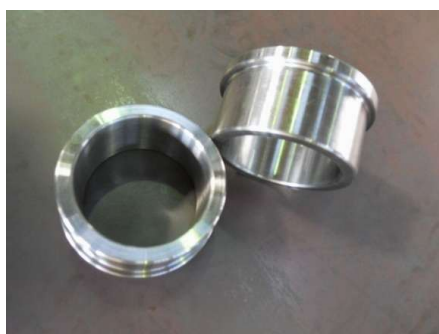
SSAB社高強度・高硬度耐摩耗鋼板 HARDOX500 車輪 精密機械加工
