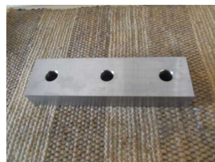
SSAB社高強度・高硬度耐摩耗鋼板 HARDOX550破砕機チップナイフ研磨加工
