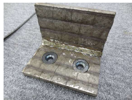
SSAB社耐摩耗肉盛鋼板 DUROXITE100 溶接と穴加工
