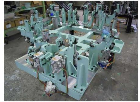
ドアフレーム溶接治具
