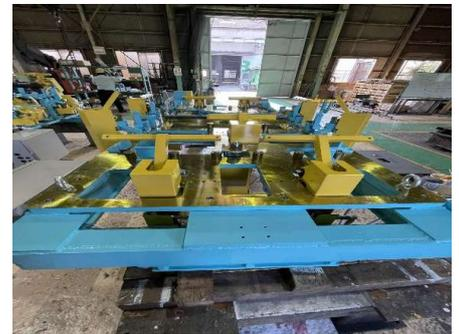
建機フレーム溶接治具
