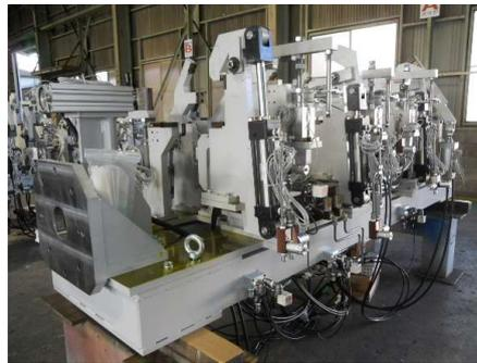
建機フレーム溶接治具
