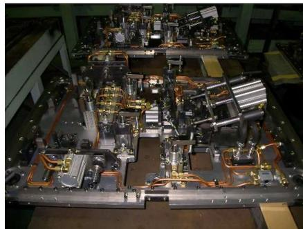
自動車フロントシートフレーム溶接治具
