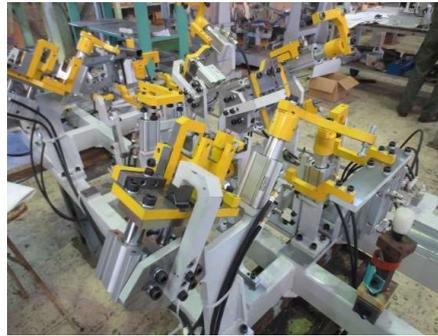
建機フレームSUB溶接治具
