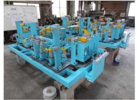
建機フレーム溶接治具
