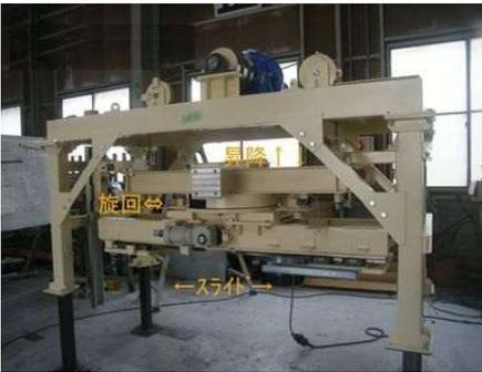
旋回、昇降、スライド付移載装置
